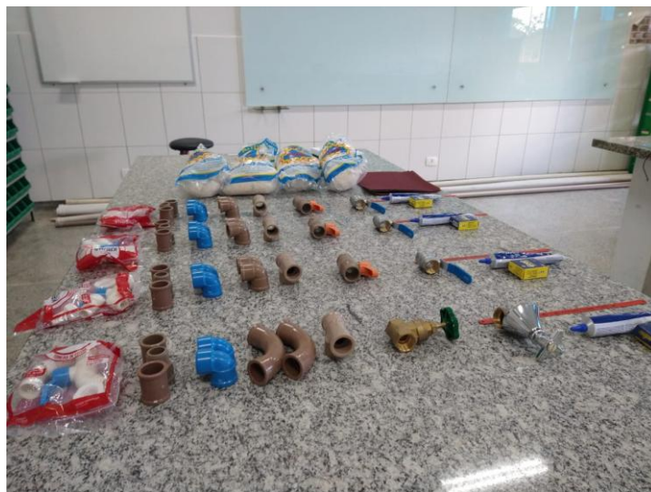
Figura 11 – Separação de Materiais, Ferramentas e EPIs para montagem de Kits Hidráulicos
