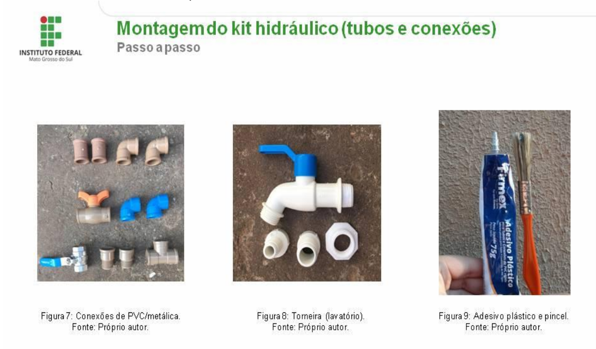
Figura 16 – Etapa executiva de separação de conexões, peças e adesivo para solda apresentada pelos estudantes em videoconferência.
