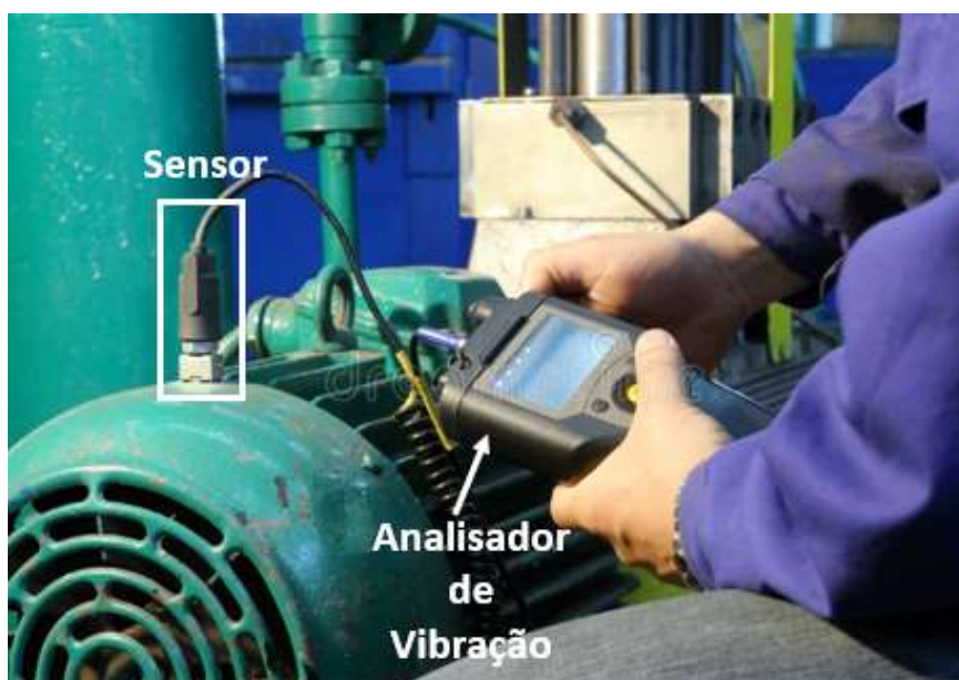
Figura 2 - Medição da vibração
