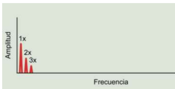
Figura 22 - Estágio 1 de deterioração do rolamento
