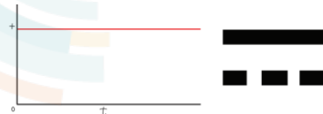
Figura: Forma de onda da corrente contínua e símbolo DC.
