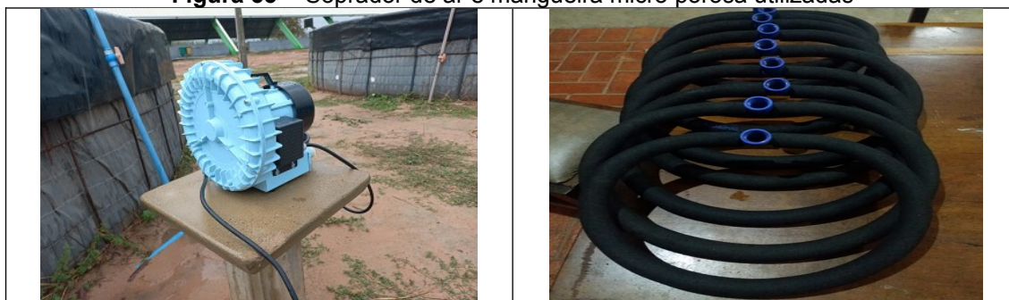
Figura 33 - Soprador de ar e mangueira micro porosa utilizadas
