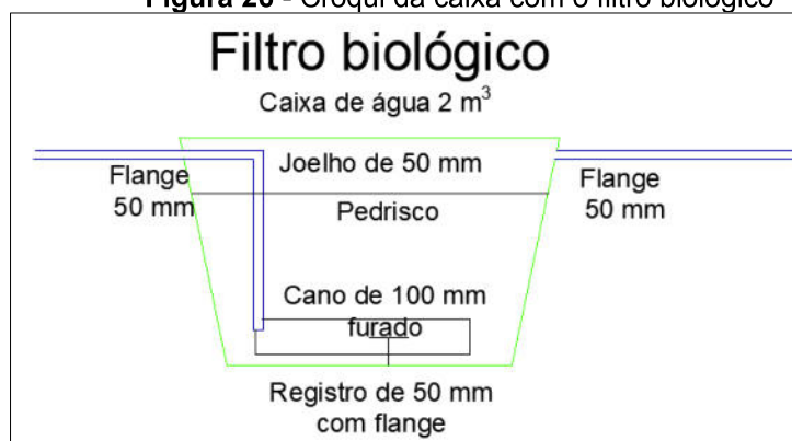
Figura 26 - Croqui da caixa com o filtro biológico
